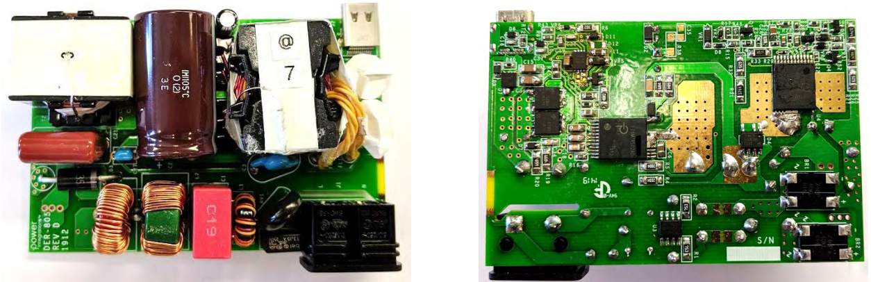
圖 6 DER-805 – 100 W 寬範圍 USB PD + PPS 充電器 (5 V – 20 V 輸出), 無需散熱片。InnoSwitch3-Pro INN3370C-H302。
