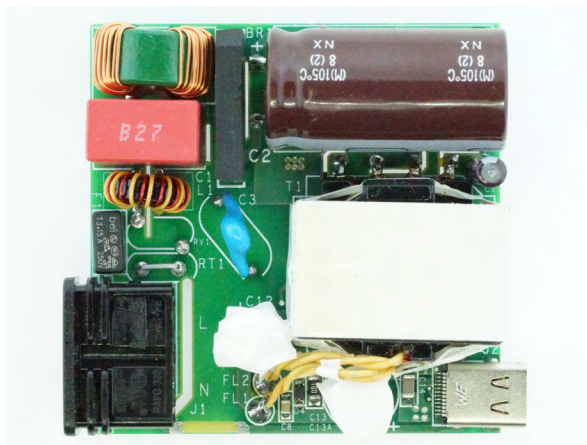
圖 5 DER-601 – 60 W 寬範圍 USB PD 充電器 (5 V – 20 V 輸出) 在整個負載範圍內均表現出高效率。InnoSwitch3-CP INN3279C-H215。60 W 轉換器設計 – 無需散熱片。
