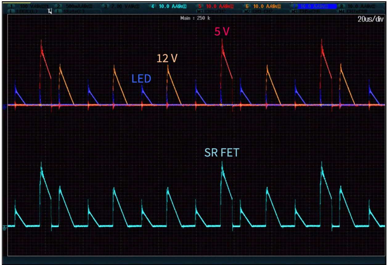
图 6 具有2个恒压输出和1个恒流输出的电源的输出电流波形
